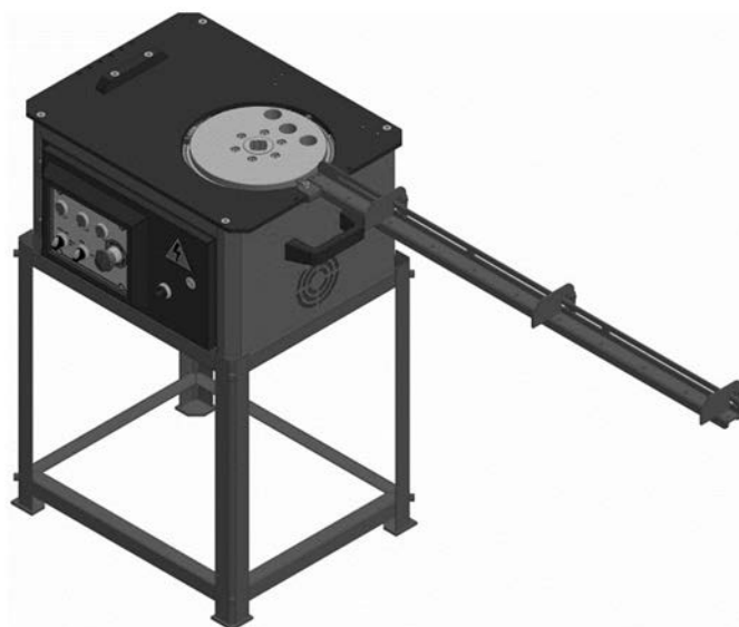
Figure 5: Cintreuse sur sa table support et muni du bras buté escamotable
